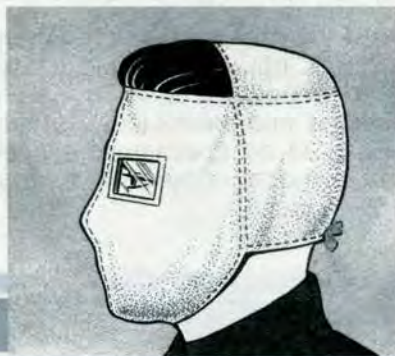
Рис. 7. Противопыльная тканевая маска ПТМ-1
