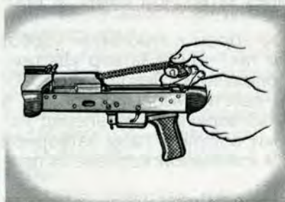
Рис. 21. Отделение возвратного механизма
