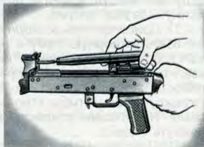
Рис. 22. Отделение затворной рамы с затвором
