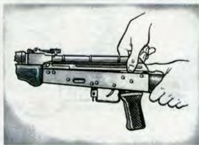
Рис. 20. Отделение крышки ствольной коробки
